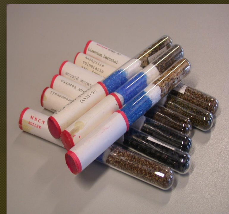
Fases de l'elaboració d'ampolles de vidre amb llavors i gel de sílice a partir d'un tub d'assaig que es tanca a la flama.
