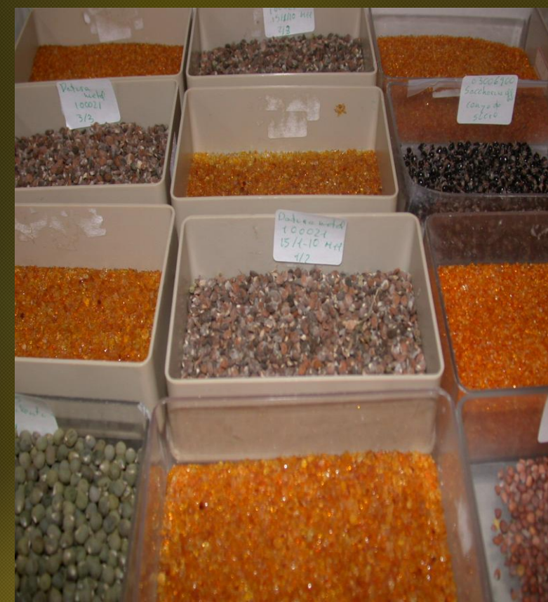
Cambra d'ultradessecació de llavors amb presència de gel de sílice.
