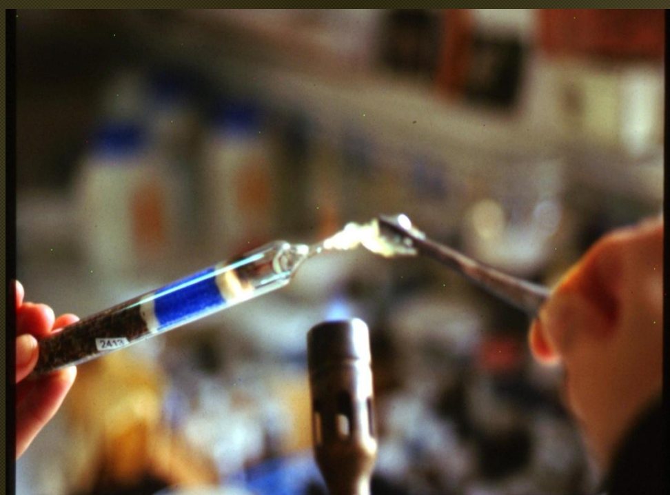
Fases de l'elaboració d'ampolles de vidre amb llavors i gel de sílice a partir d'un tub d'assaig que es tanca a la flama.
